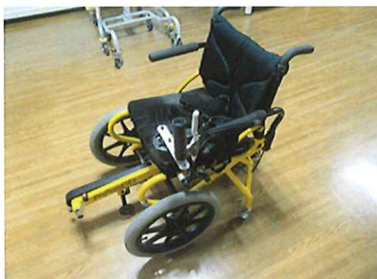
足漕ぎ車いす
